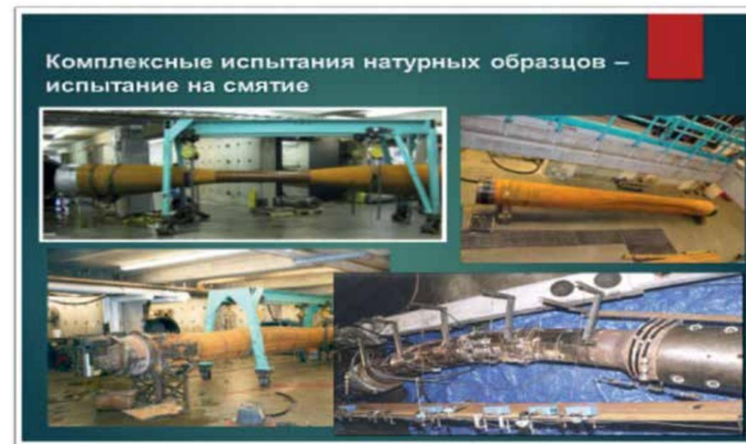
Рис. 2. Испытания натуральных образцов труб (источник — Intecsea)
