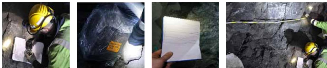
Рисунок 3. а – измерения азимута одной из систем трещин, б – измерения волнистости трещины, в – игольчатый гребень для измерения шероховатости трещин, г – фиксация шероховатости трещин, д – упаковка отобранных образцов, е – измерение шероховатости игольчатым гребнем
