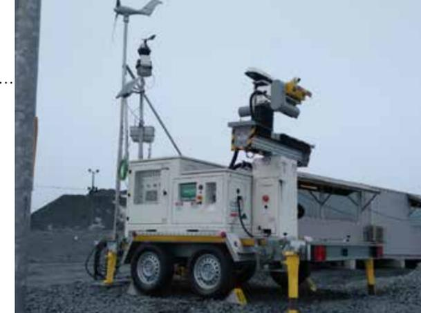
Рисунок 5. Применение наземного радара IBIS при наблюдении за потенциально опасным участком на месторождении Болиден Кевиста, Финляндия
