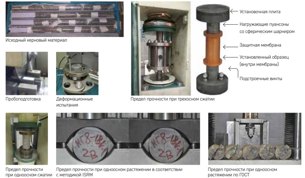
Рисунок 7. Проведение физико-механических испытаний образцов
