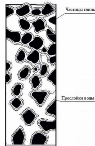
Рис. 5. Схема соединения глинистых частиц
