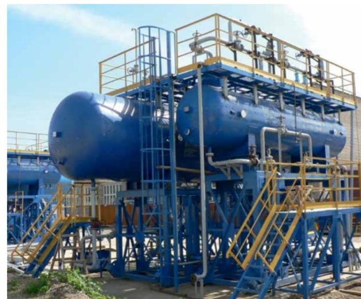
Рис. 2. Малогабаритная блочная сепарационно-наливная установка
