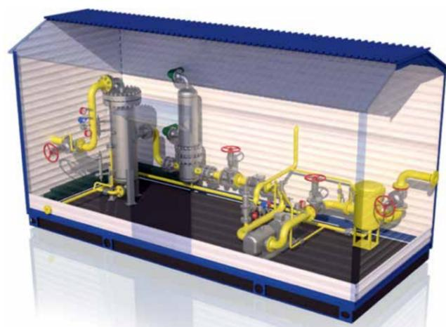
Рис. 3. Модульный блок подготовки и раздачи реагентов
