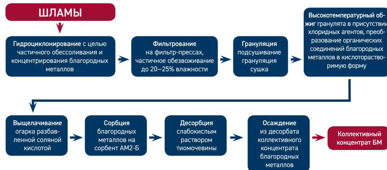
Рис. 2. Схема переработки шламов
