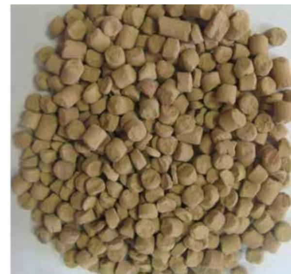
Рис. 6. Огарок-гранулят, обожженный при температуре 900°C
