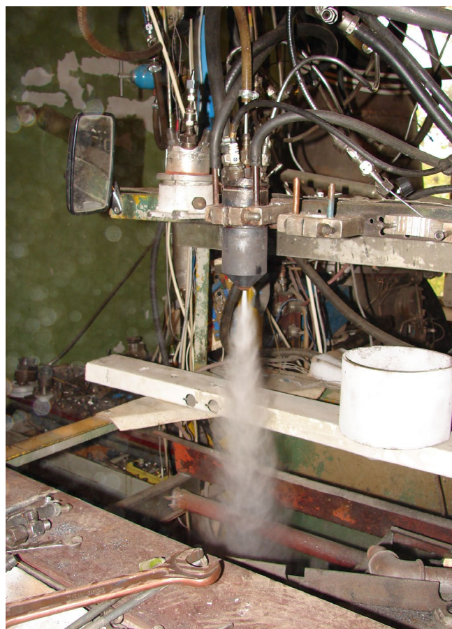
Фото 1. – Стендовая работа генератора мелкодисперсного аэрозоля с балластом воды 20 г/с
