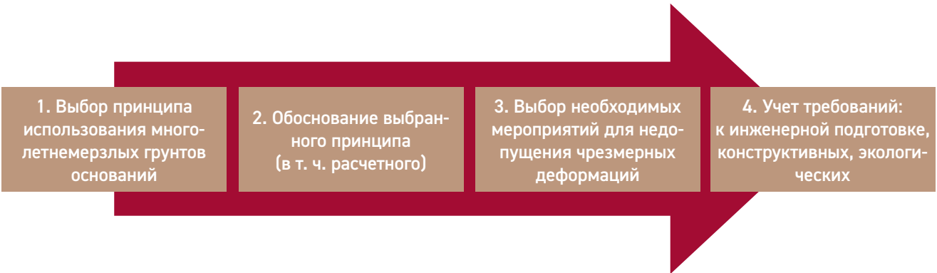
Рис.1. Блок-схема основных действий при проектировании объектов с наличием ММГ основания
