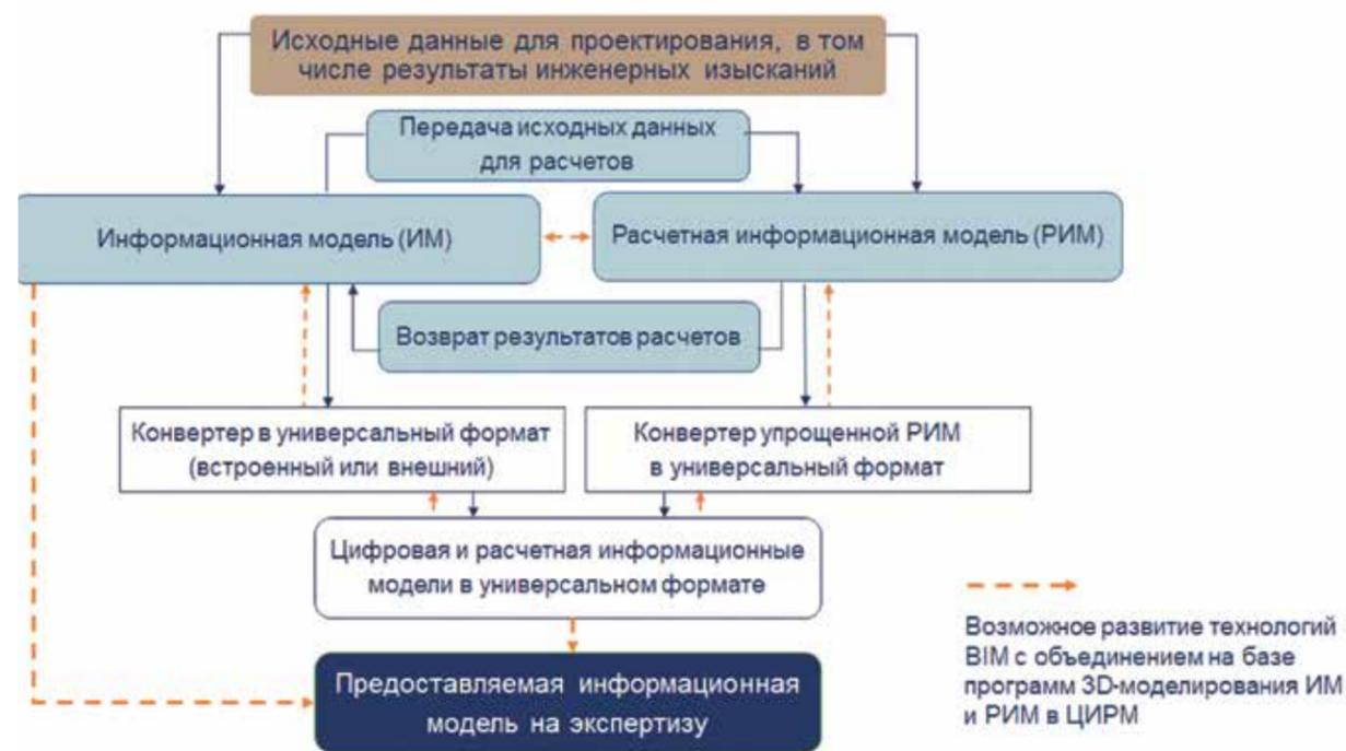
Рис. 1. Алгоритм подготовки результатов расчетов с использованием информационного моделирования
